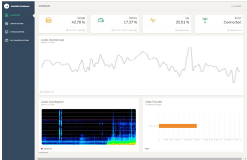
초음파 음향데이터를 활용한 설비 고장진단 서비스 '왓치벳'의 모니터링 이미지 (사진 제공 : 모빅랩)
